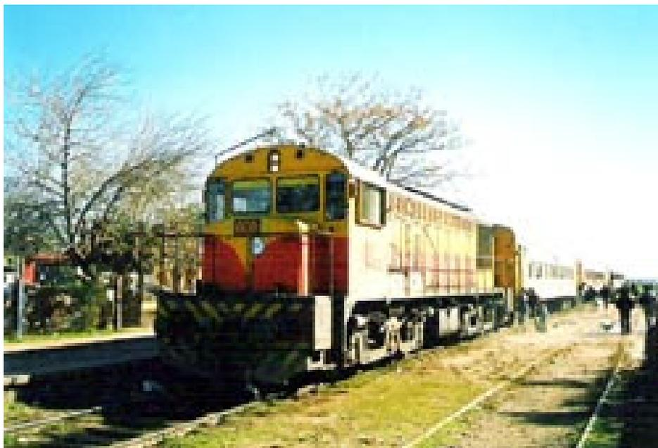
**Locomotora diesel Alco serie 313**
